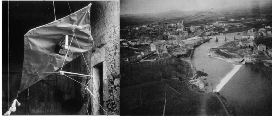
Fig. 4 Aparatul de zbor cu dispozitivul foto atașat, utilizat de Arthur Batut, și fotografia aeriană, efectuată în Labruguière 17,18
