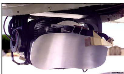
Fig. 4 Senzori SAR/GMTI, de tipul Lynx I (AN/APY-8) 21
